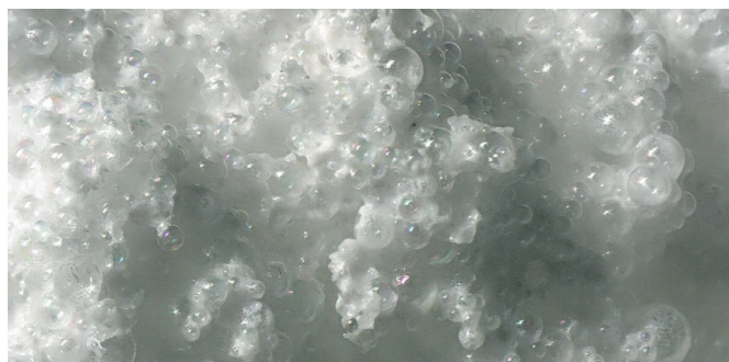
Termoizolační plnivo v nátěrové hmotě.
